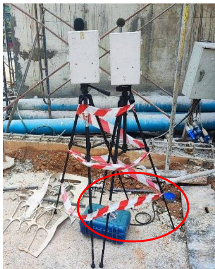
รูปที่ 3.15 การตรวจวัดความสั่นสะเทือนภายในพื้นที่โครงการ
